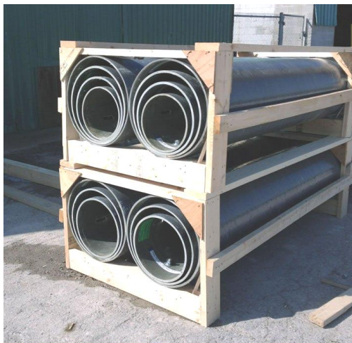
Рисунок 1. Принцип хранения и перевозки композитных опор.
