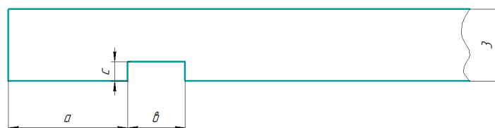
Рисунок 1. Стальная пластина толщиной 3 мм с дефектом типа «пропил»
