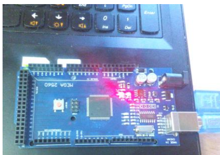
Рисунок 2. Соединение платы Arduino Mega 2560 с ноутбуком посредством USB-кабеля.
