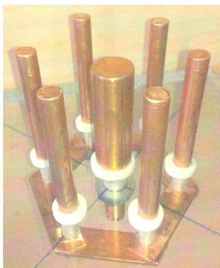
Рисунок 1. Электродная система экспериментального термоядерного реактора «Плазменный фокус 4».
