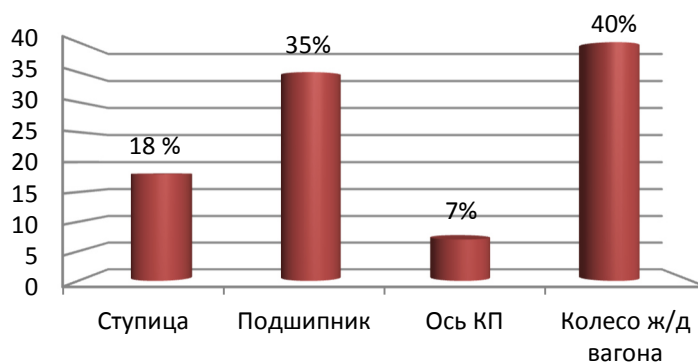
Рисунок 1.13 – Виды отказов по конструкциям колесных пар
