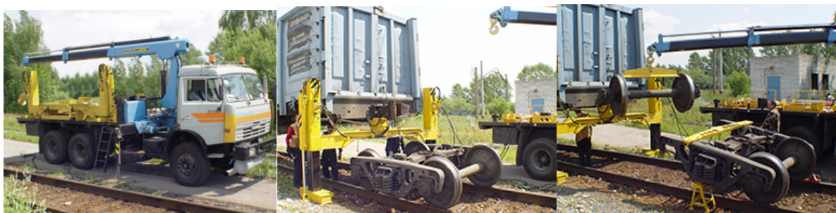
Рисунок 4.2 - Ремонтный железнодорожный комплекс РК-1М
