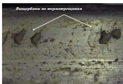
Рисунок 1.19 – Термотрещины в выщербине
