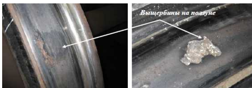
Рисунок 1.17 - Форма двойного дефекта - выщербины на ползуне
