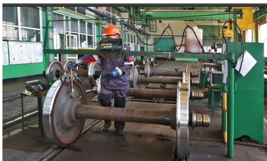
Рисунок 3.1 – Колеса толстые многократного ремонта
