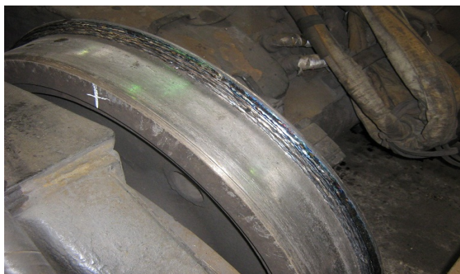
Рисунок 4.3 – Изношенный гребень колесной пары, восстанавливаемый разработанным мобильным комплексом
