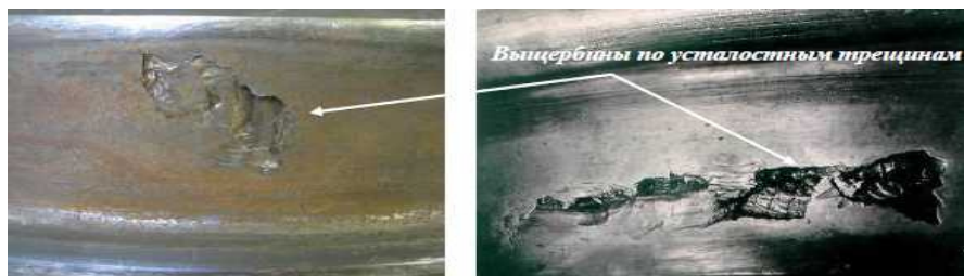
Рисунок 1.18 – Результат выщербины по месту образования усталостных трещин
