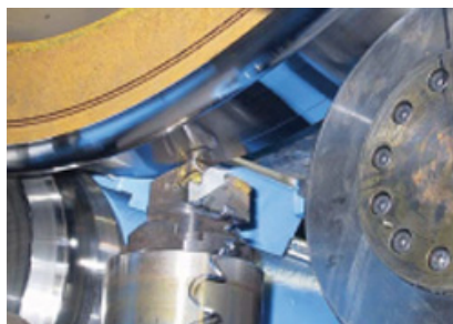
Рисунок 3.2 – Восстановления профиля колеса по копиру
