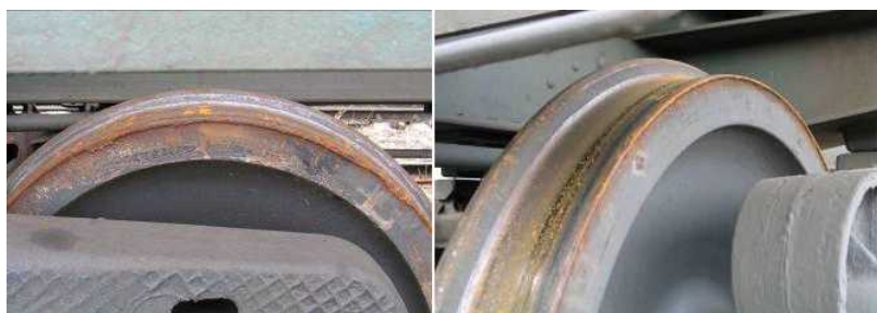
Рисунок 1.16 - Результат текучести материала колеса
