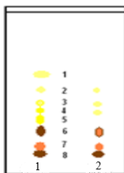
Рисунок 21 - Тонкослойная хроматография хлористометиленового экстракта субстанции баротермическим (1) и экстракционным способами (2)
