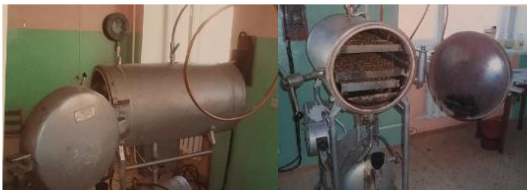
Рисунок 11 - Баротермическая установка на основе медицинского автоклава
