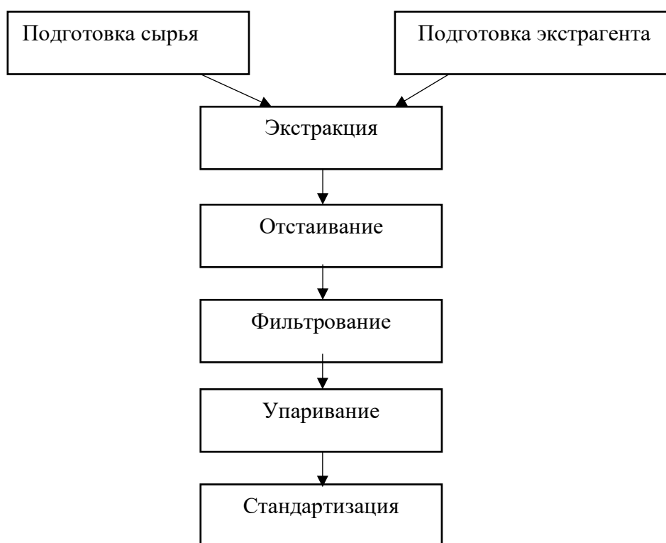
Рисунок 10 - Технологические операции извлечения густой субстанции из почек тополя методом экстракции
